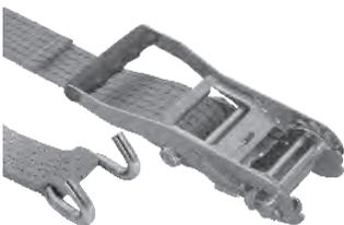
2-teilig, Gewebe, mit Klauenhaken, Dehnung <5%, GS & TÜV-Zeichen, gemäß DIN EN 12195-2, Farbe: rot, mit eingenähtem Label Fest- und Losende und Artikelnummer und Skala zwecks Prüfdatum.
