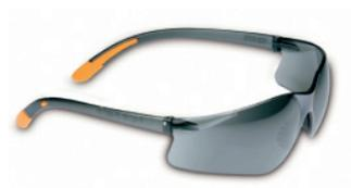
Schutzbrille mit UV-Schutz, verspiegelt, Komfortkissen an den Bügelenden, weiche, universell passende Nasenpolster, optisch korrekte einteilige Polycarbonat-Scheibe, kratzfeste Beschichtung. DIN EN 166 Kl.1.
